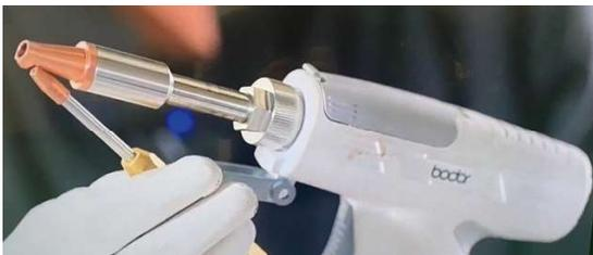
レーザー溶接機用小型ガン
